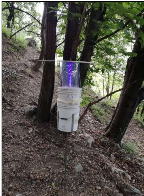
Figura 14. Trappola luminosa utilizzata per la cattura di lepidotteri notturni, dove è visibile la lampada a LED accesa, fonte luminosa attrattiva per le falene
